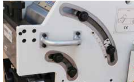
Ángulo chaflanado preciso. Exact Bevel angle.
