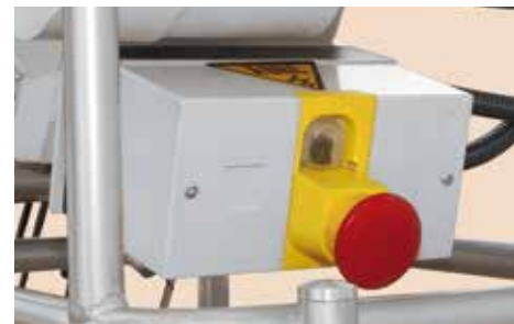
Caja eléctrica accesible. Accessible electric box.
